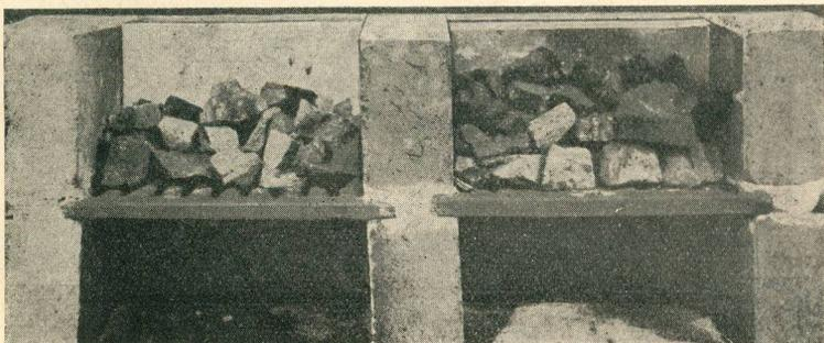
Bild 16. a zu großer, b durch Schamottestein hinten verkleinerter Rost.
