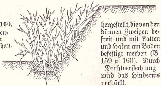
hergestellt, die von den dünnen Zweigen befreit und mit Latten und Haken am Boden befestigt werden (B. 159 u. 160). Durch Drahtverflechtung wird das Hindernis verstärkt.
